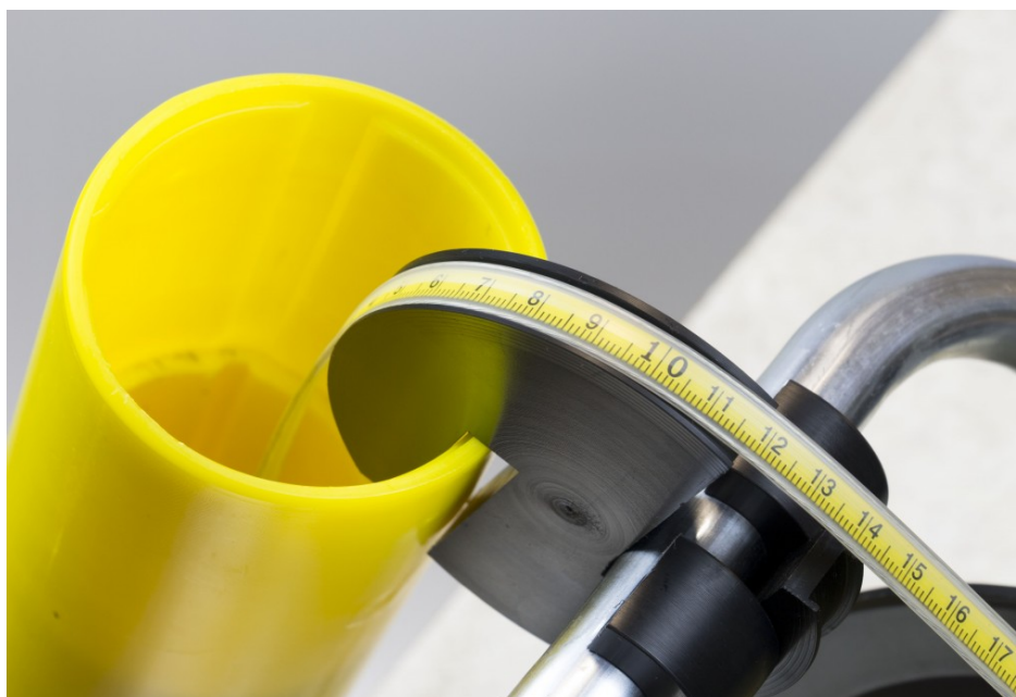
Рис. 7. Расположение мерной ленты датчика на контрольном элементе
